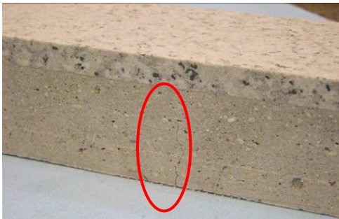
Ejemplo de Rotura no neta, tras ensayo de flexión.
